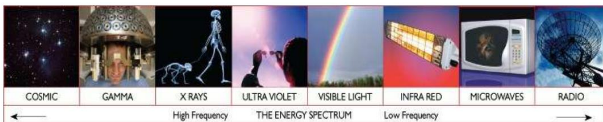
Рисунок 1.1 – Схематичне зображення спектру електромагнітного випромінювання
