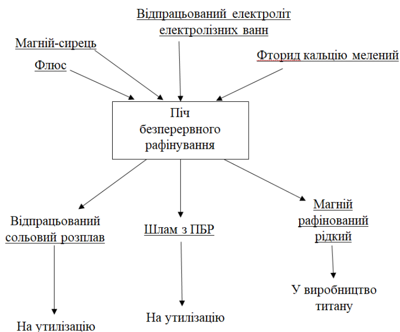
Рисунок 1.7 – Технологічна схема рафінування магнію-сирцю
