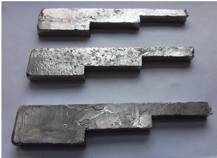
Рисунок 3.4 – Експериментальні зразки для дослідження впливу ширини штаби та величини обтиску на розширення до прокатки.
