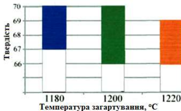
Рисунок 3.7 - Вплив температури загартування на твердість карбідосталі
