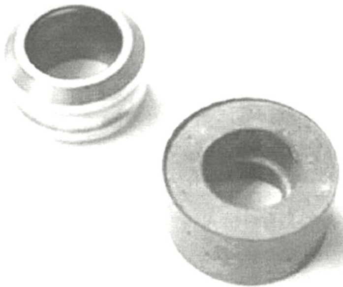
Рисунок 1.2 - Ролик дротяного стану, виготовлений механічною обробкою спеченої штампованої заготовки
