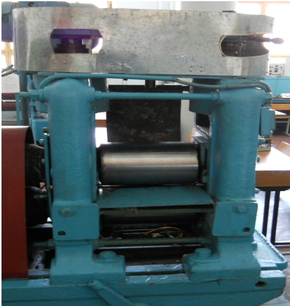
Рисунок 2.1 - Лабораторний двовалковий стан з діаметром сталевих валків D=200\text{мм}
