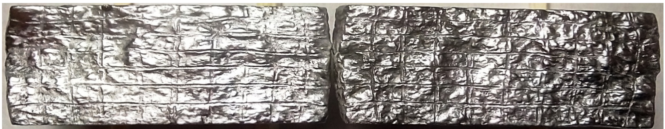
Рисунок 2.11 – Фото координатної сітки осадженого образцю з змащуванням торців образцю мастилом на нафтовій основі з графітом, H=20\text{мм} , D=30\text{мм} на \varepsilon = 33\%
