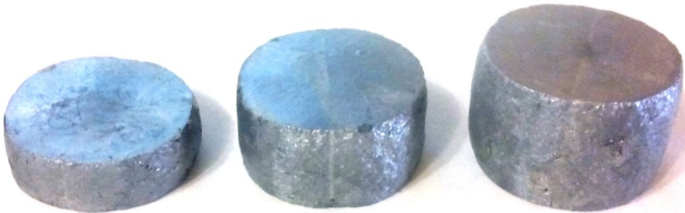
Рисунок 2.4– Фото комплекту осаджених зразків з змащуванням торців чистим вазеліном, E= 30\% .
