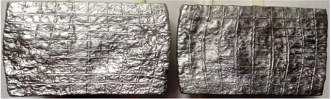
Рисунок 2.9 – Фото координатної сітки осадженого образцю з змашуванням торців образцю вазеліном, H=30\text{мм} , D=30\text{мм} на \varepsilon = 30\%
