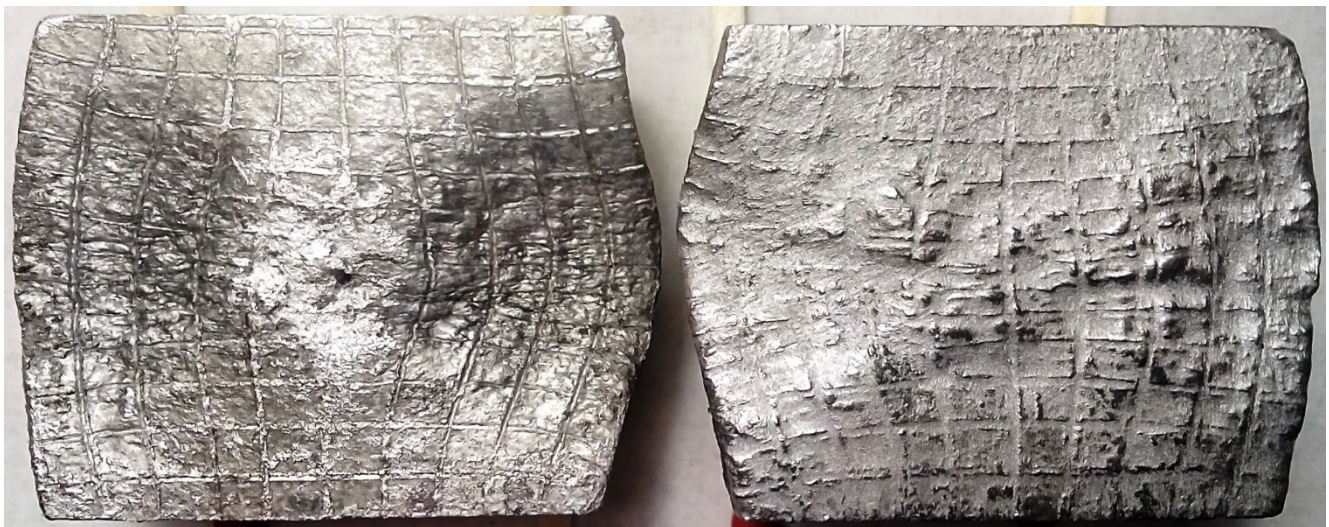
Рисунок 2.7 – Фото координатної сітки осадженого образцю на сухих, обезжирених плитах, H=40\text{мм} , D=30\text{мм} на \varepsilon = 30\%
