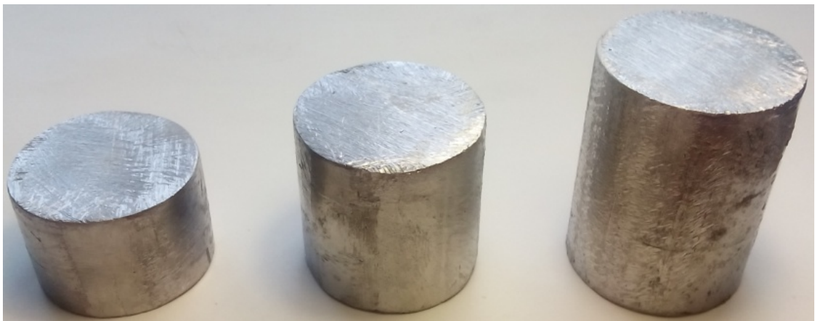
Рисунок 2.2 – Фото комплекту доопрацьованих і готових до осаджування зразків
