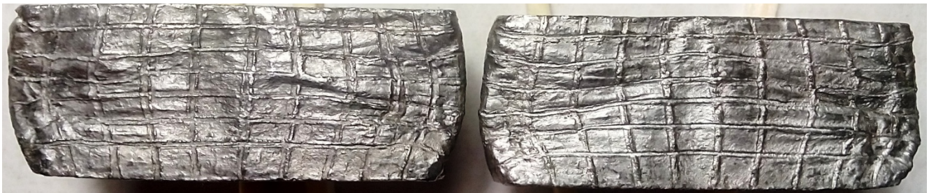
Рисунок 2.5 – Фото координатної сітки осадженого образцю на сухих, обезжирених плитах, H=20\text{мм} , D=30\text{мм} на \varepsilon = 31\%
