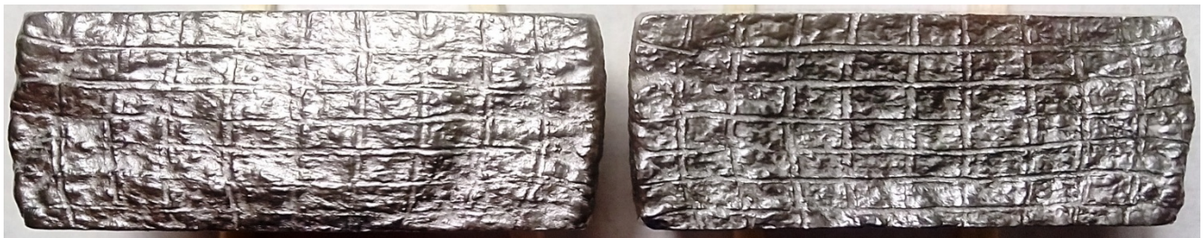
Рисунок 2.8 – Фото координатної сітки осадженого образцю з змащуванням торців образцю вазеліном, H=20\text{мм} , D=30\text{мм} на \varepsilon = 32\%
