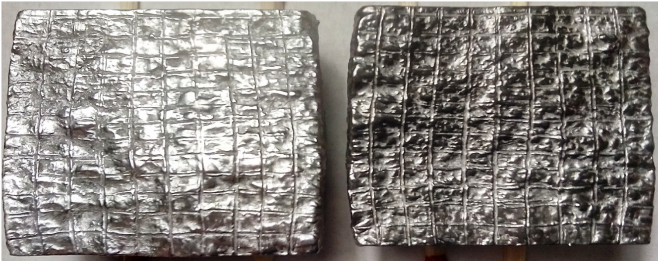
Рисунок 2.13– Фото координатної сітки осадженого образцю з змащуванням торців образцю мастилом на нафтовій основі з графітом, H=40\text{мм} , D=30\text{мм} на \varepsilon = 31\%
