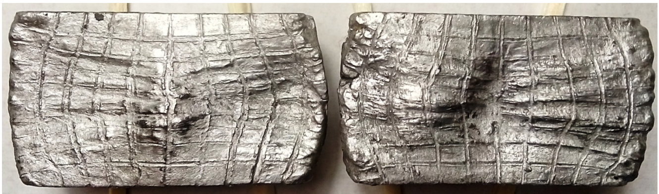
Рисунок 2.6 – Фото координатної сітки осадженого образцю на сухих, обезжирених плитах, H=30\text{мм} , D=30\text{мм} на \varepsilon = 32\%
