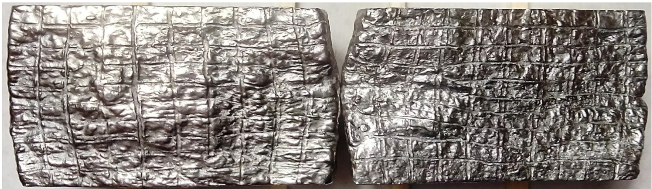
Рисунок 2.12 – Фото координатної сітки осадженого образцю з змащуванням торців образцю мастилом на нафтовій основі з графітом, H=30\text{мм} , D=30\text{мм}
