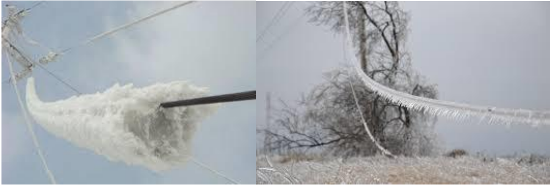
Рисунок 1.4 – Обрив ЛЕП через перевантаження
