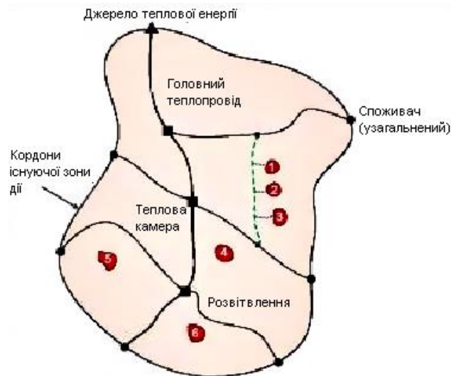
Рисунок 1.5 – Проектування зон з індивідуальним тепlopостачанням в існуючій зоні дії централізованого тепlopостачання
