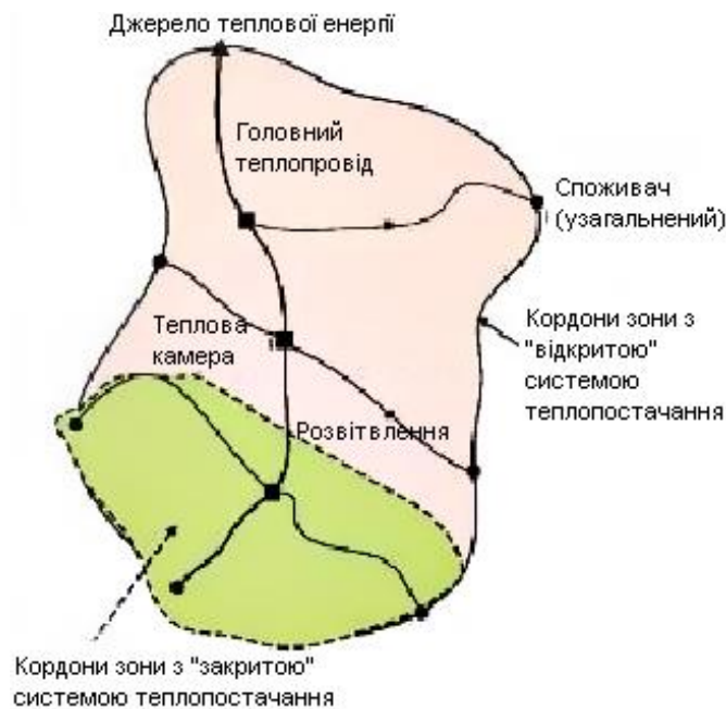
Рисунок 1.6 – Ізольована система теплопостачання з різним типом під'єднання споживачів до теплових мереж
