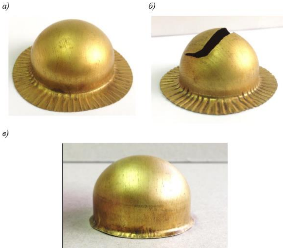
Рисунок 3.15 – Заготовки з латуні Л68, отримані методом ЕГІ витяжки-формування: а – традиційна ЕГІ на межі можливостей; б – традиційна ЕГІ за передозування енергії; в – інтенсифіковане ЕГІ витяжка-формування
