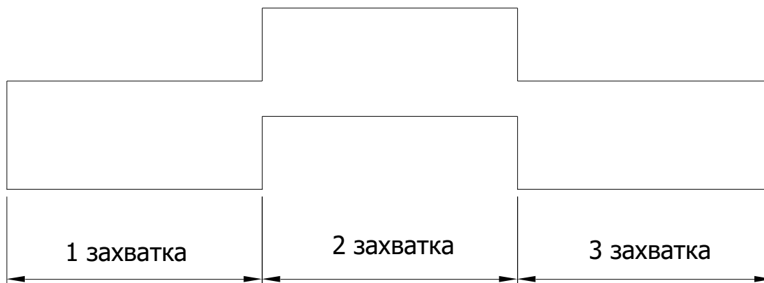
Рисунок 3.1 – Схема розподілу будівлі на захватки
