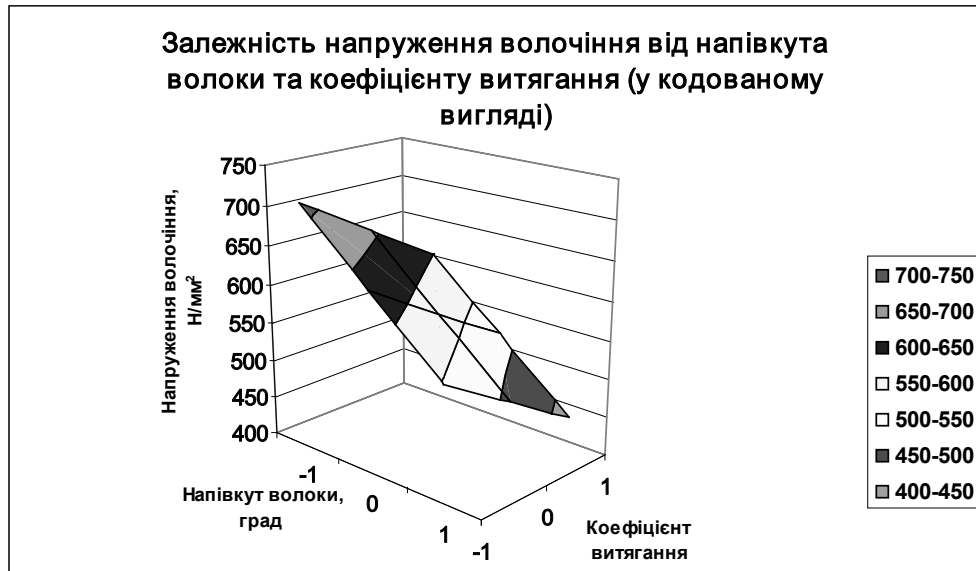
Рисунок 3.6. Поверхня отримана в кодованому виді y = 573,75 - 83,5 \cdot X_1 - 57,25 \cdot X_2
