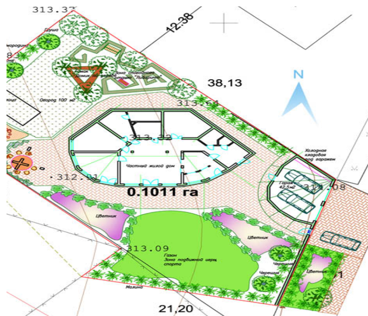
Рисунок 3.12 – Генплан ділянки будівництва «пасивного» будинку
