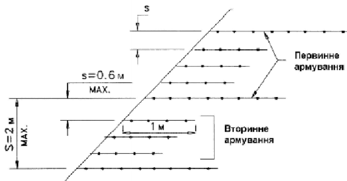
Рисунок 3.2 – Схема закладання полотен вторинного армування між полотнами первинного
