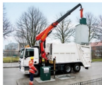
Фото. Завантаження контейнерів підземного розташування
