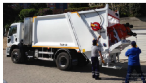
Фото. Сміттєвоз НІДРО МАК з функцією миття та дезінфекції контейнерів
