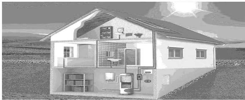
Рисунок 1.4 - Приклад функціонування сонячної системи для гарячого водопостачання
