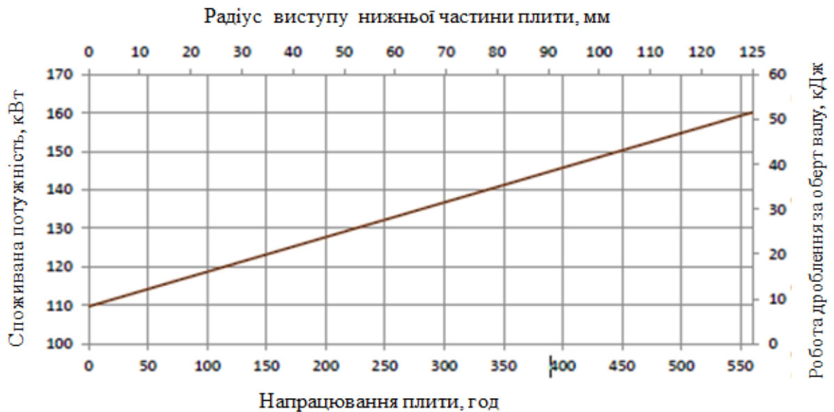
Рисунок 2.14 - Зміна потужності споживаної дробаркою СМД-118 та роботи дроблення за оборот валу в міру експлуатації плит через зношування їх виступів.
