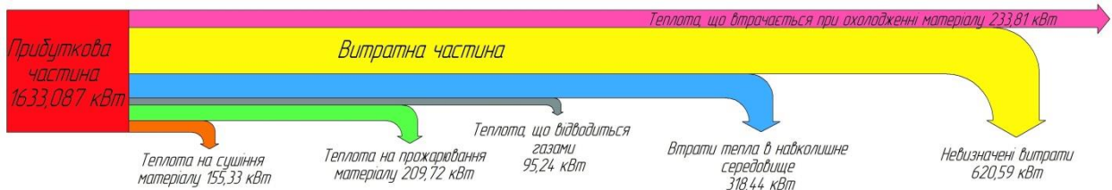
Рисунок 1.8 – Діаграма Сенкі енергетичного балансу сушильного барабана
