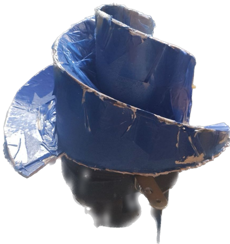
Рис. 3.7 – Ротор «Онiпка» з кутом нахилу шнеків 45^\circ .
