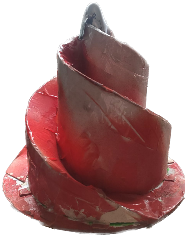
Рис. 3.9 - Ротор «Оніпка» з кутом нахилу шнеків 62^\circ .
