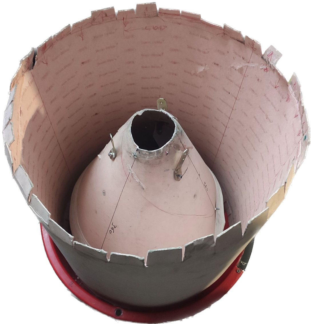
Рис. 3.11 – Центральний конфузор з байпасом.
