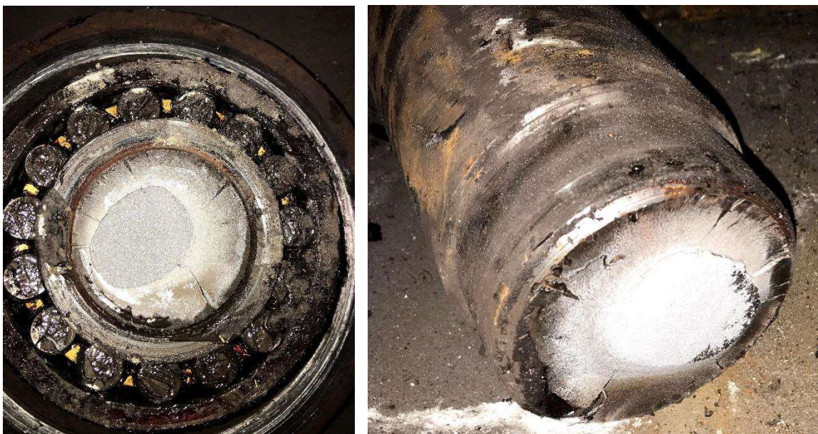
Рисунок 1.8 – Аврійна ситуація в зв'язку з поломкою трансмісійного валу
