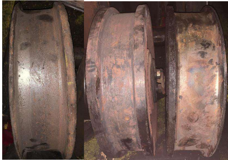
Рисунок 1.9 – Знос реборд кранових коліс
