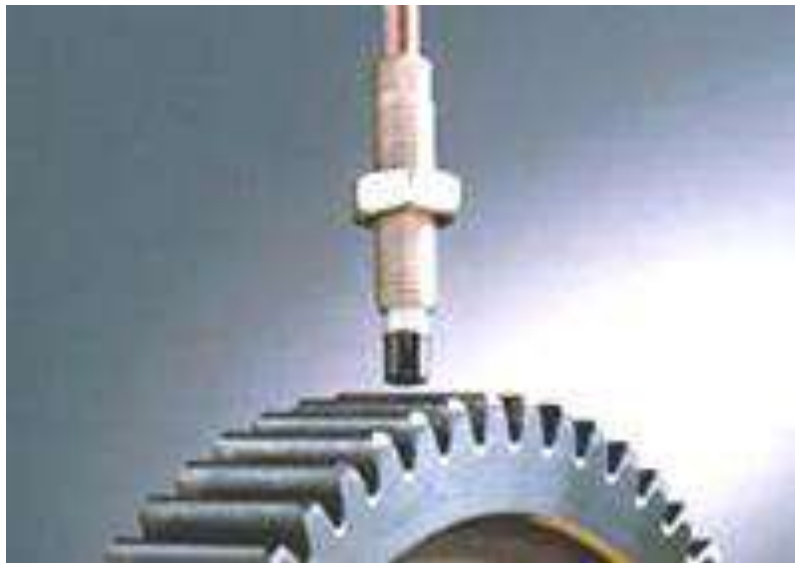
Рисунок 3.12 – Зразок встановлення датчика для визначення частоти обертання зубчатого колеса
