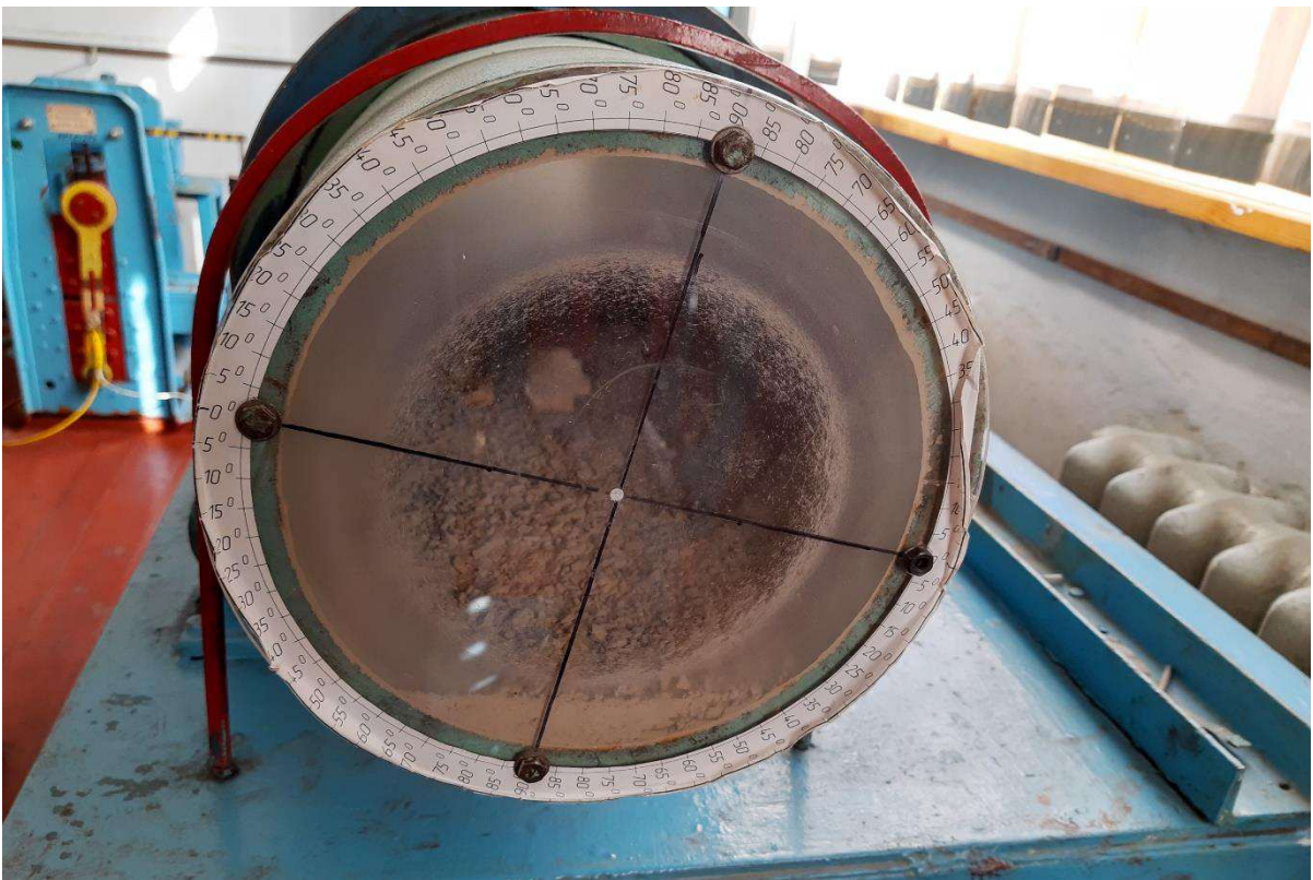
Рисунок 3.14 – Модель змішувача-огрудковувача зі сторони оглядового вікна
