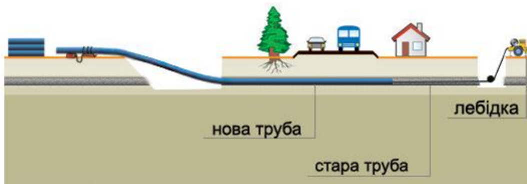
Рисунок 3.1 –Ремонт трубопроводу з мінімальними технічними складнощами і можливістю проведення в умовах щільної міської забудови
