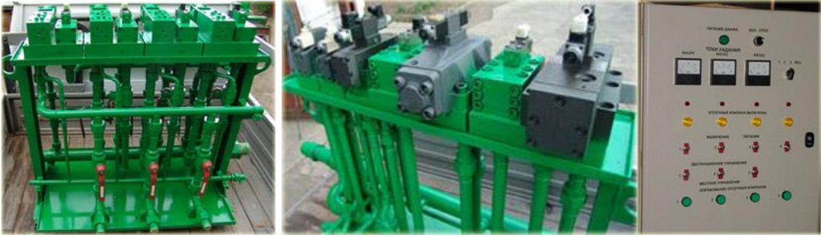
Рисунок 1.3 - Гідропанель PRM оснащений шафою для електричного управління.
