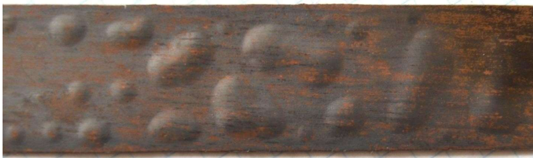
Рисунки 1.11 - Бульбашки на поверхні біметалу
