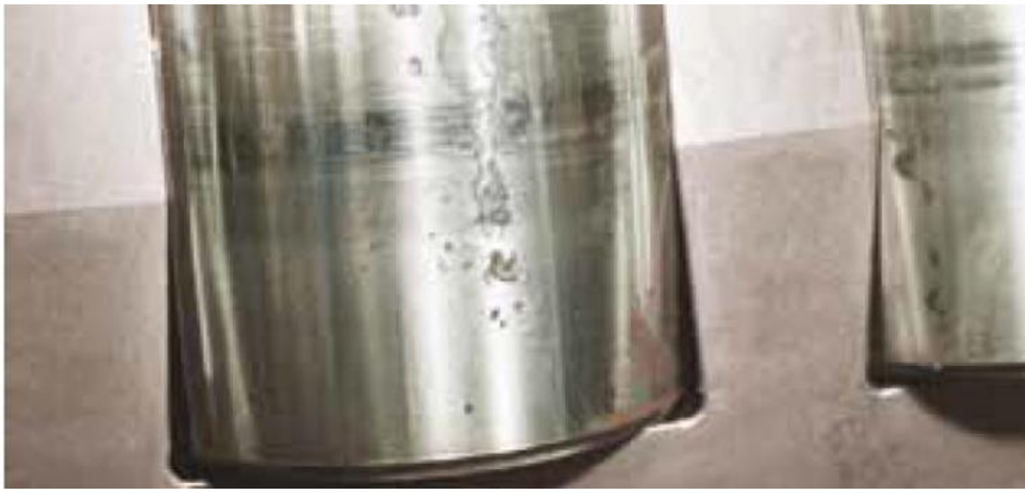
Рисунок 2.16 – Дефектність роликів сферичного роликотішипника (викликана краплями вологи)
