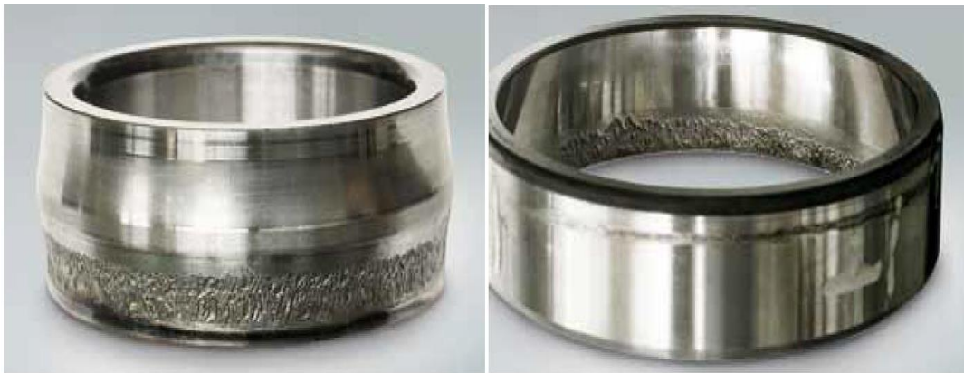
Рисунок 2.29 – Внутрішнє та зовнішнє кільця сферичного роликотпідшипника з ознаками втомного відшаровування
