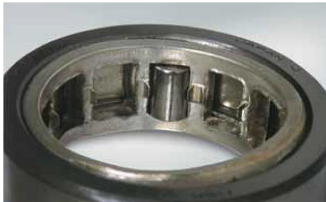
Рисунок 2.28 – Сепаратор циліндричного роликпідшипника з наявністю дефектів
