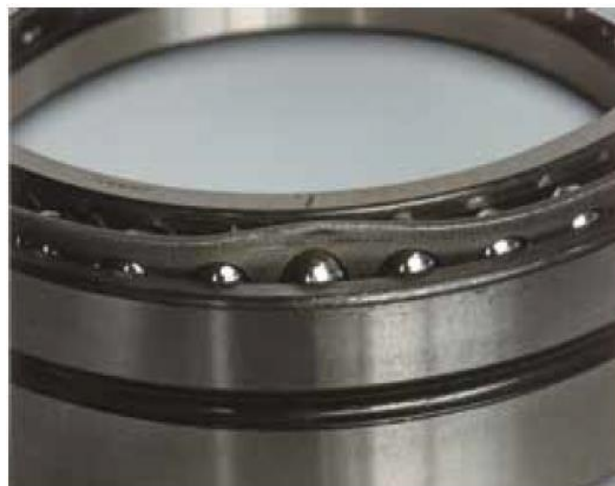
Рисунок 2.24 – Сепаратор радіально-упорного шарикopідшипника з дефектом, викликаним його еформуванням при встановці на вал
