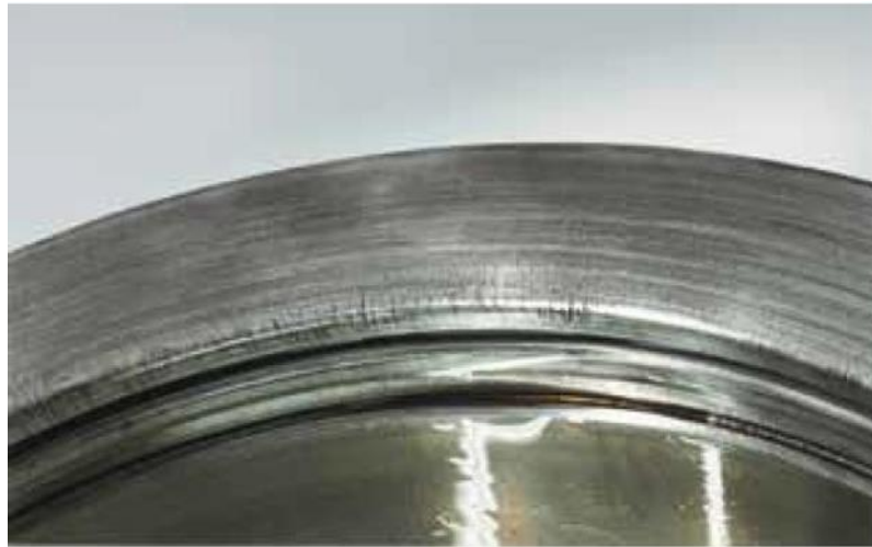
Рисунок 2.23 – Внутрішнє кільце сферичного роликopідшипника з термічними тріщинами на боковій поверхні
