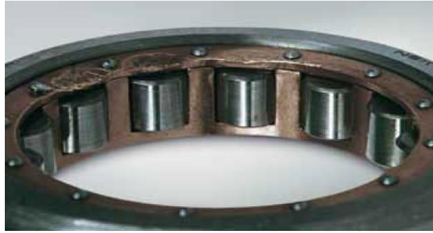
Рисунок 2.25 – Сепаратор циліндричного роликopідшипника з дефектом, викликаним його деформуванням при встановці на вал
