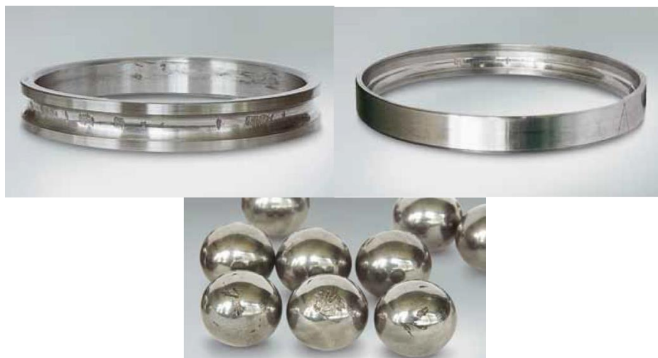
Рисунок 2.31 – Елементи радіально-упорного шарикopідшипника з ознаками втомного відшаровування, яке викликане ударним навантаженням при монтажі
