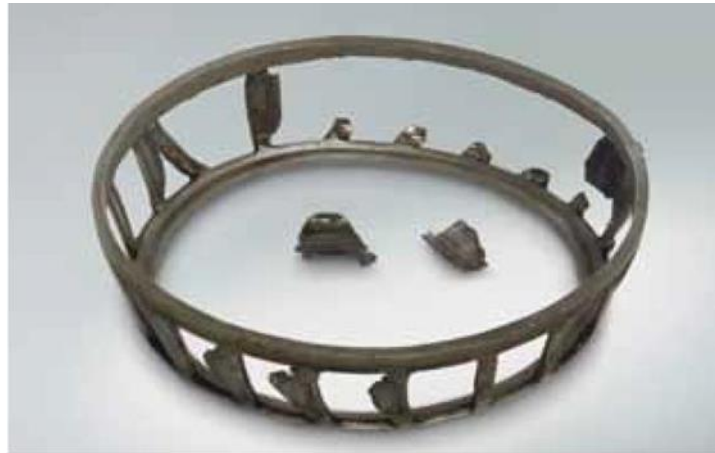
Рисунок 2.27 – Сепаратор конічного роликпідшипника з наявністю дефектів
