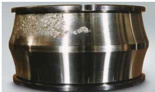
Рисунок 2.30 – Внутрішнє кільце сферичного роликopідшипника з ознаками втомного відшаровування
