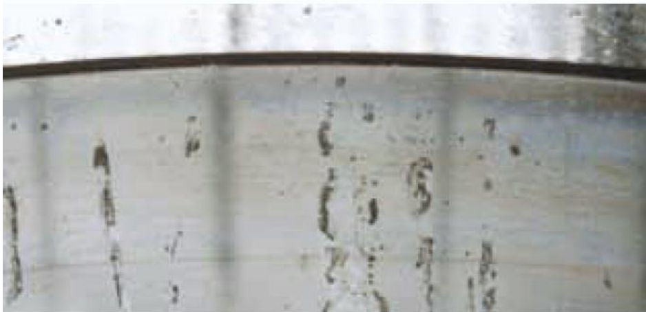
Рисунок 2.15 – Дефектність внутрішнього кільця підшипника зі сферичними роликами (викликана краплями вологи)
