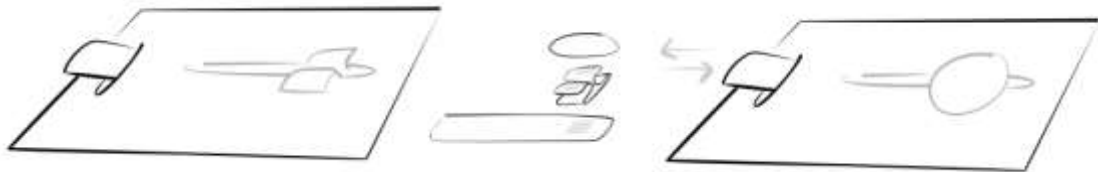
Витяжний штовхач (The slot-guided pull strip) зі закритим керуванням паралельного площинного елемента
