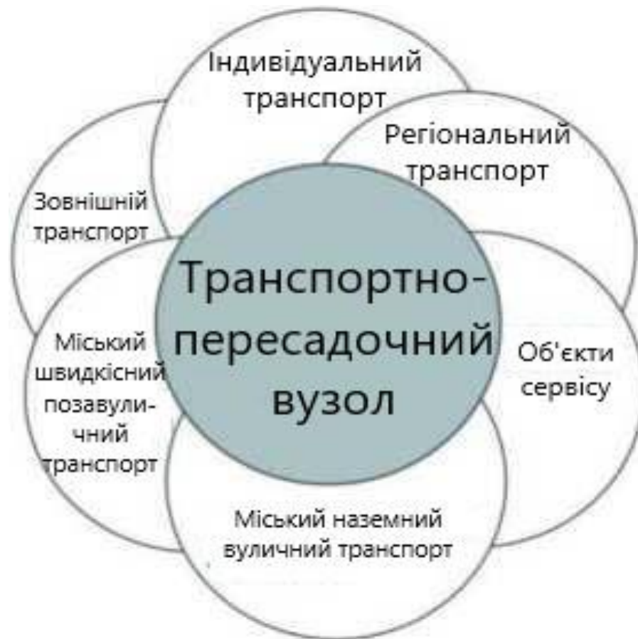
Рисунок 1.1 - Принципова схема сучасного ТПВ
