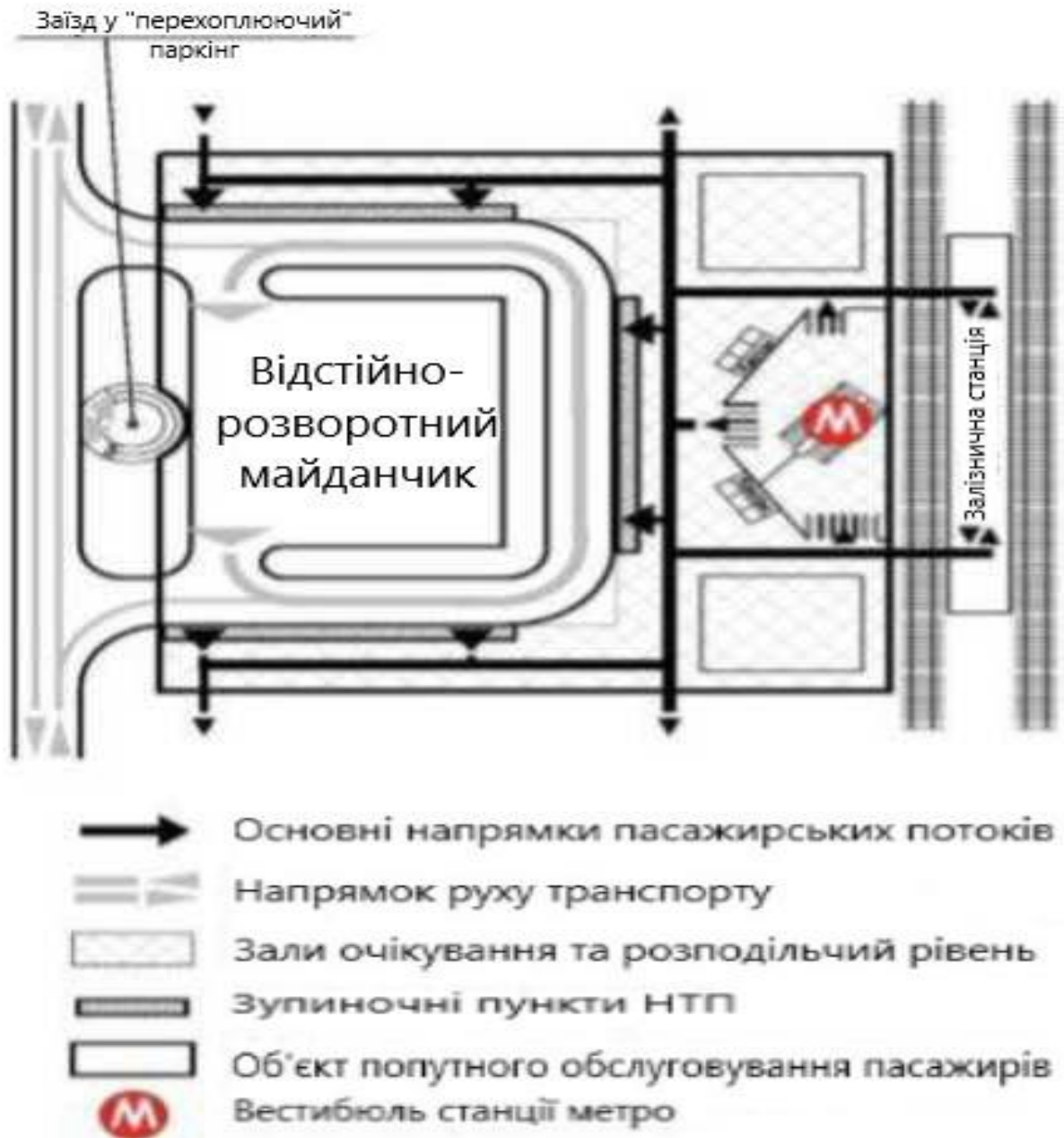
Рисунок 3.5 - Варіант планувального рішення ТПВ агломераційного значення з пересадковим комплексом берегового типу
