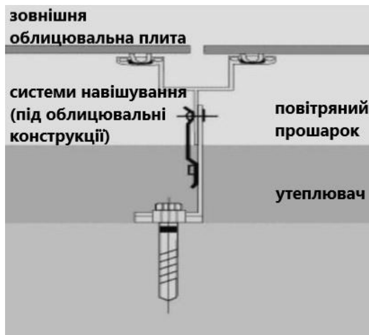
Рисунок 1.16- Конструкція вентильованого фасаду (вид зверху)
