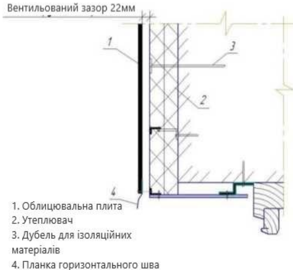
Рисунок 2.3 - Вузол примикання навісного фасаду до віконного отвору
