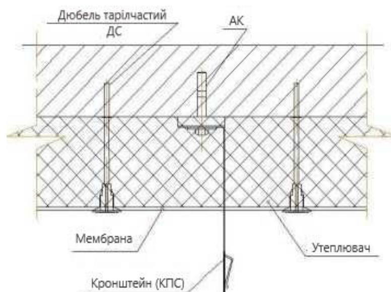
Рисунок 2.1 - Монтаж кронштейна в товщі несучої огорожі
