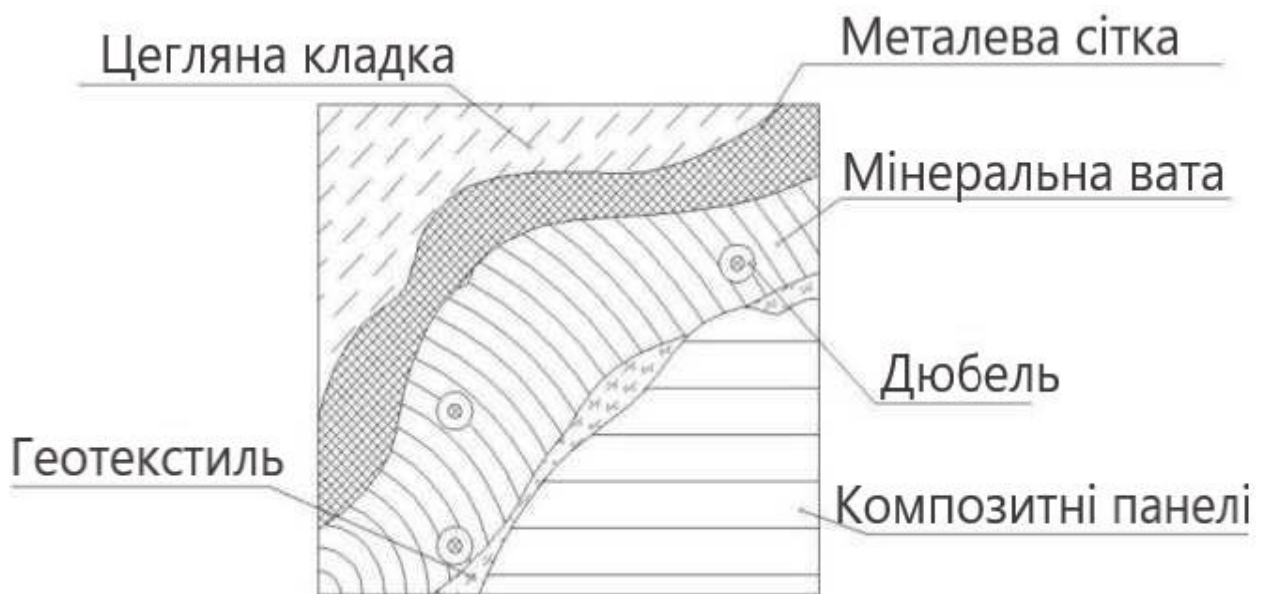
Рисунок 2.15 - Мінераловатний утеплювач під час монтажу систем НФС
