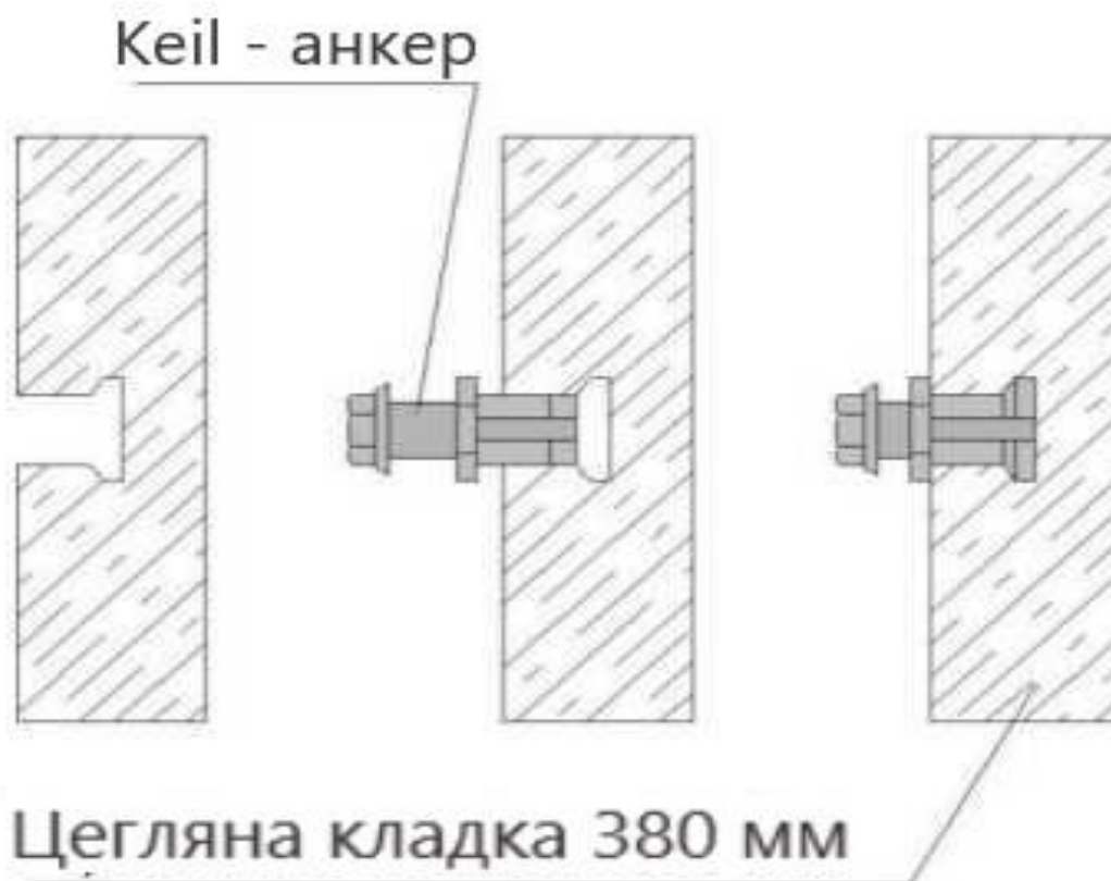
Рисунок 2.12 - Монтаж Keil – анкерів
