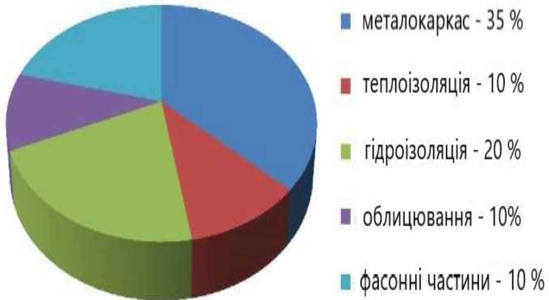
Рисунок 1.17 - Пайове співвідношення трудовитрат за окремими видами робіт при монтажі зовнішньої огорожі, що утеплює
