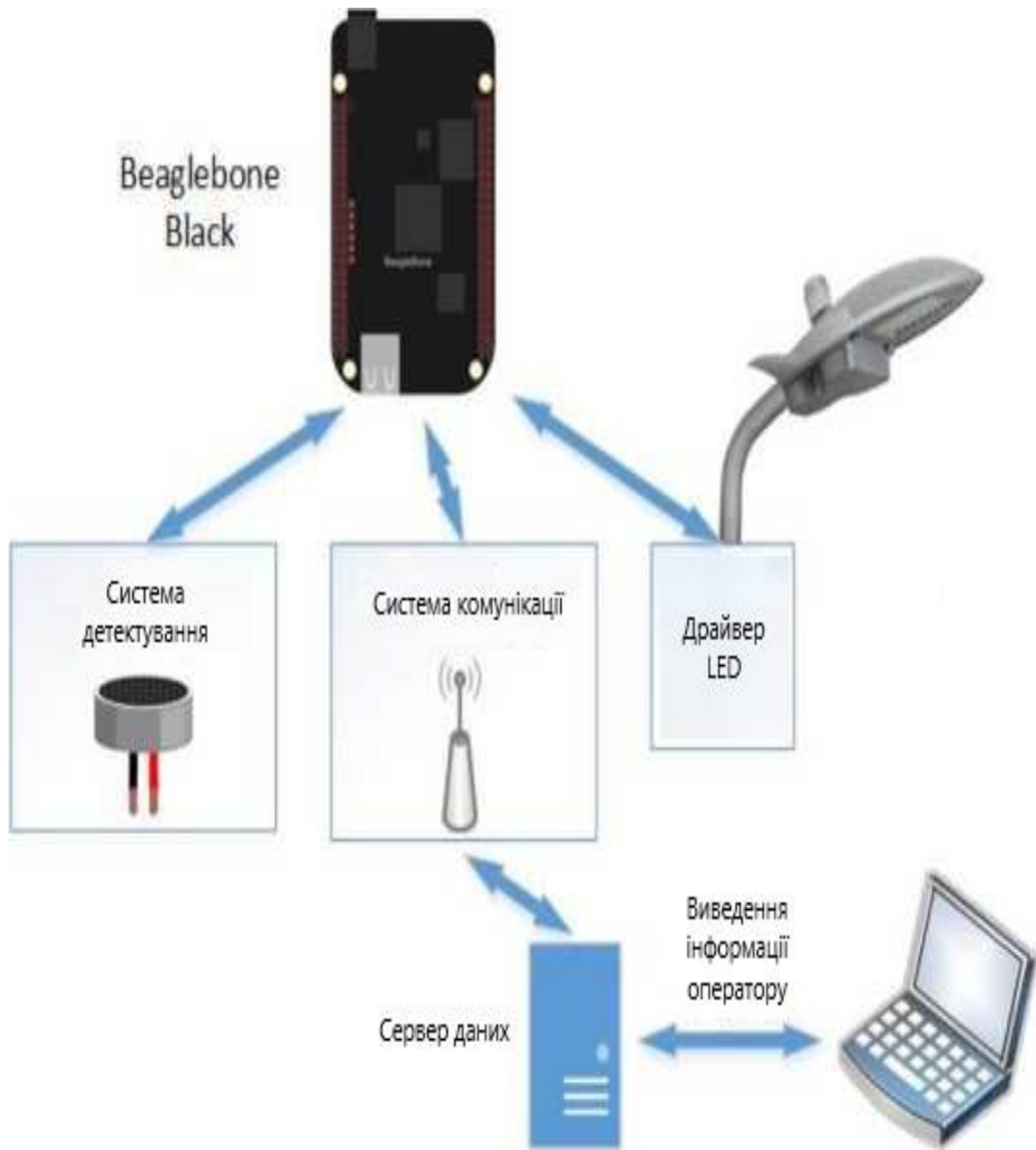
Рисунок 1.2 – Структурна схема інтелектуальної системи освітлення
