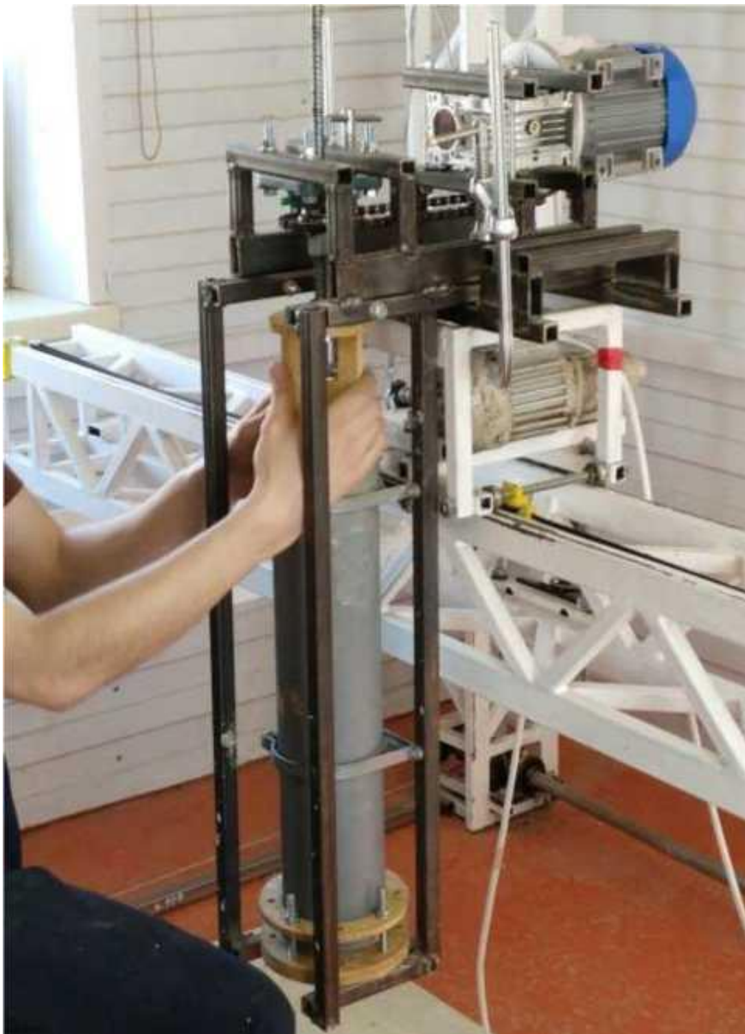
Рисунок 2.16 - Встановлення екструдера в друкувальну головку
