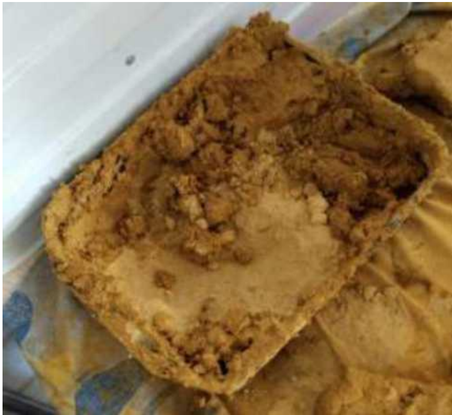
Рисунок 2.13 - Змішування глини з водою
