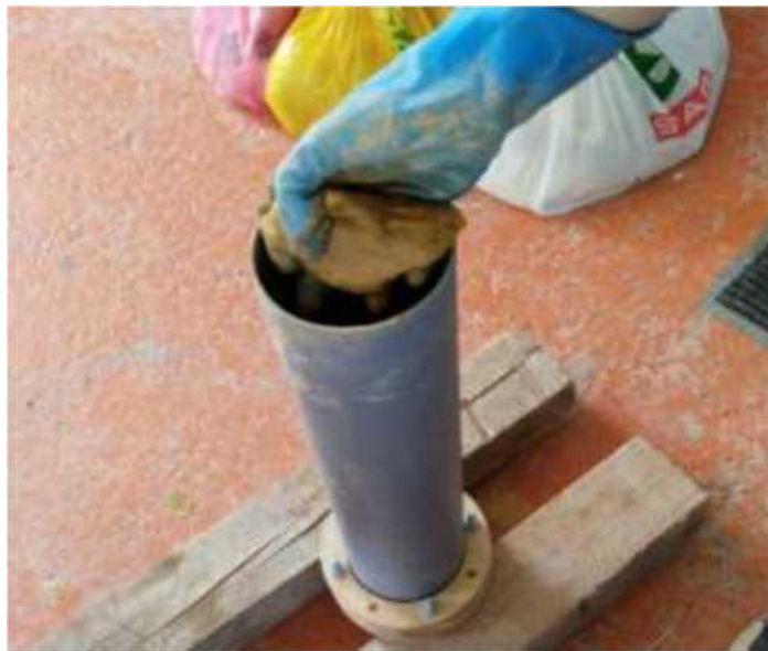
Рисунок 2.15 - Завантаження одержаної маси в екструдер
