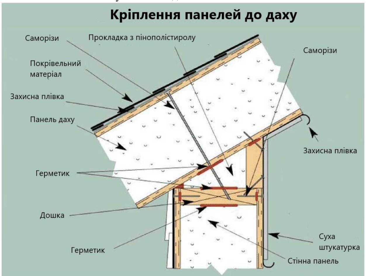
Рисунок 1.7 -З'єднання СІП панелей
