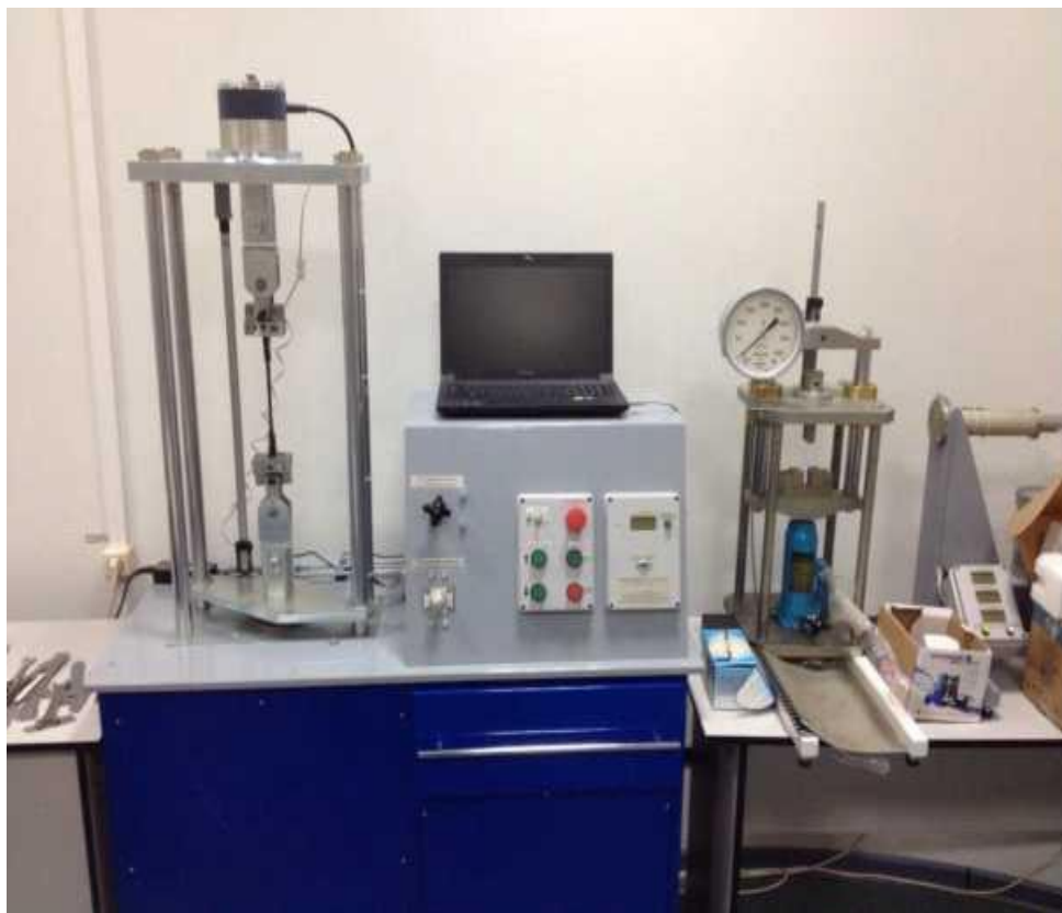
Рисунок.2.3 - Універсальна випробувальна машина "Механічні випробування матеріалів" МІМ-7ЛР-010
