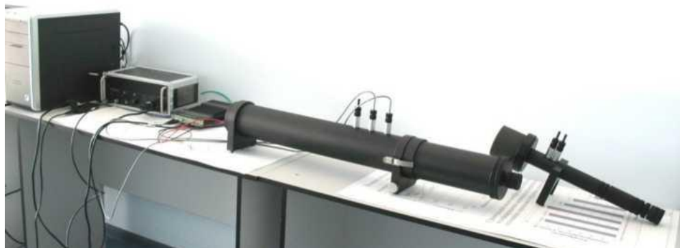
Рисунок 2.2 - Труба для вимірювання імпедансу за ASTM типу 4206
