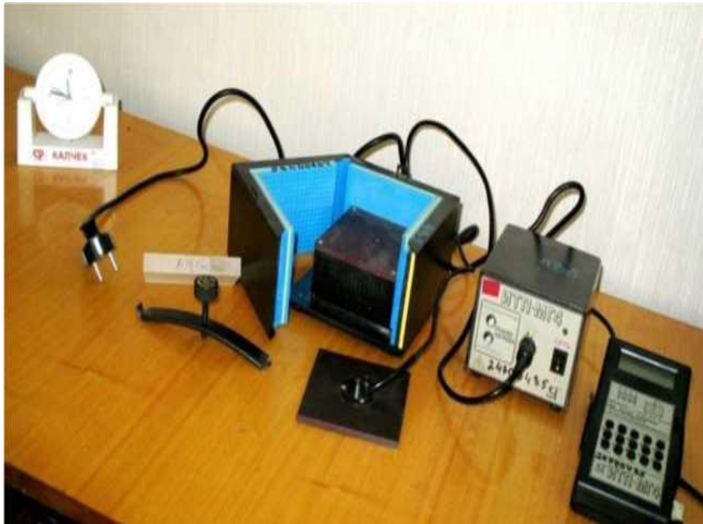
Рисунок 2.1 - Електронний вимірювач теплопровідності ІТП-МГ4
