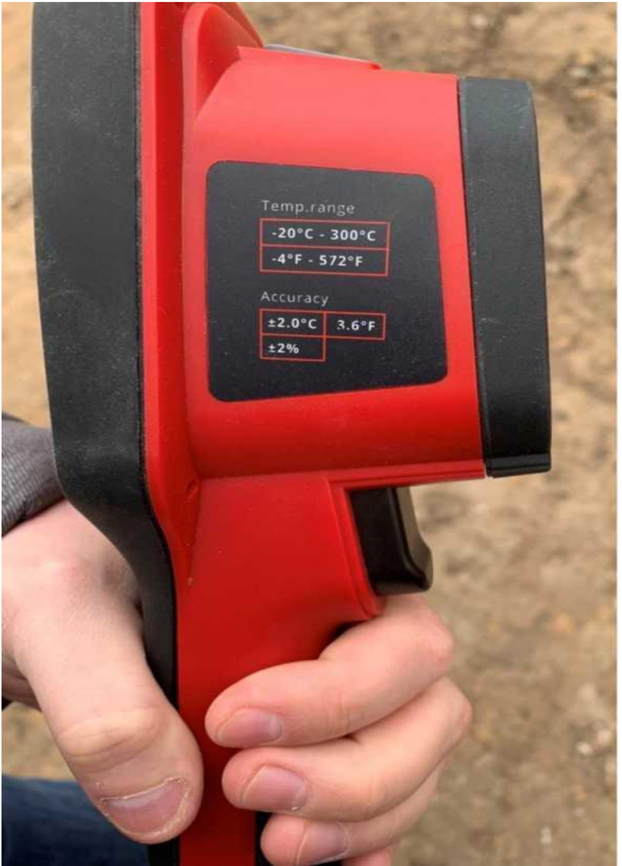
Рисунок 2.5 - технічні характеристики тепловізора TemPro VISION фірми виробник ADA INSTRUMENTS
