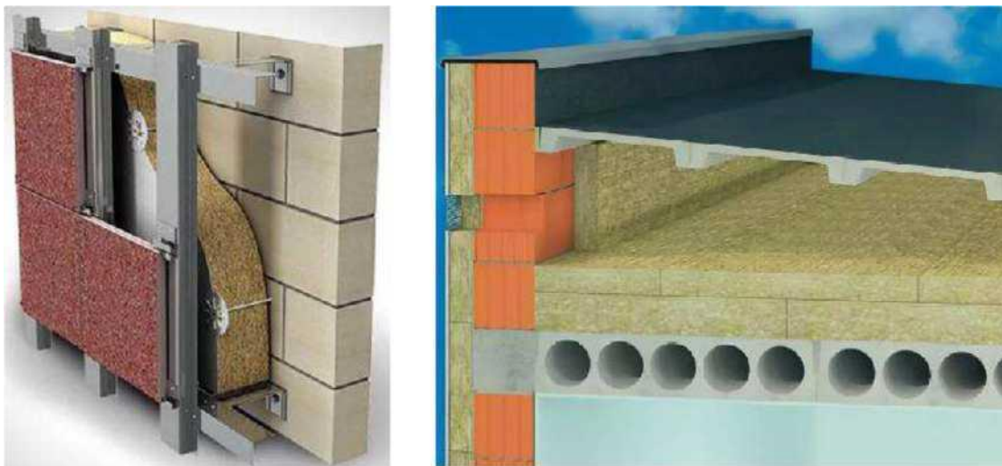
Рисунок 2.14 – Вентильована стіна та перекриття
