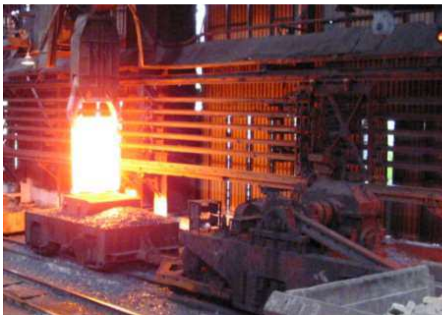
Рисунок 1.8 – Посадка зливка у візок зливковоза кліщовим краном
