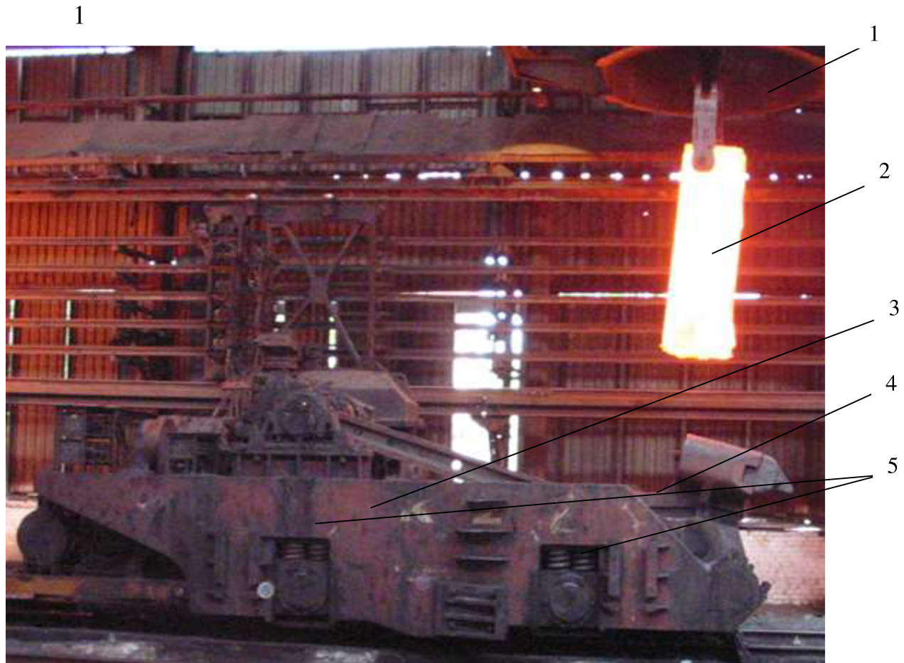
Рисунок 1.9 – Посадка зливка кліщовим краном в люльку зливковоза: 1 – кліщовий кран, 2 – зливок, 3 – зливковоз, 4 – люлька, 5 – гвинтові пружини
