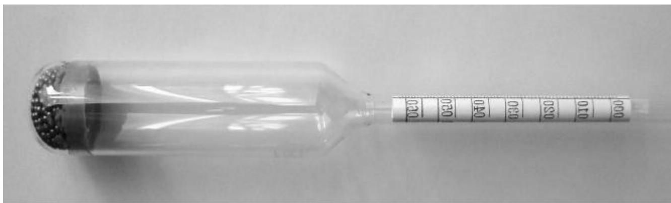
Рисунок 42 – Ареометр: 1 – баласт (дроб); 2 – маса, яка зв'язує баласт; 3 – шкала густини ареометра; 4 – шкала термометра ареометра
