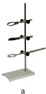
Рисунок 15 – Металічні прилади: а– металічний лабораторний штатив; б – пробіротримач
