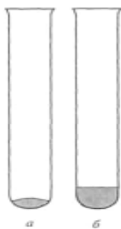
Рисунок 14 – Рекомендована кількість реагентів для проведення якісних дослідів: а) тверда речовина; б) розчин
