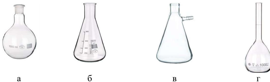
Рисунок 3 – Плоскодонні колби: а – сферичні колби зі шліфом; б – конічна колба (колба Ерленмейера); в – колба Бунзена; г – мірна колба на 1000 мл
