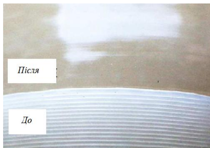
Рисунок 3.2 – Поверхня FDM-моделі до та після обробки
