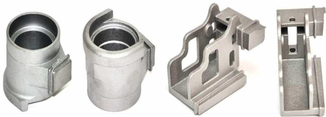
Рисунок 3.3 – Виливки, отримані за технологією FDM-моделей, що випалюються
