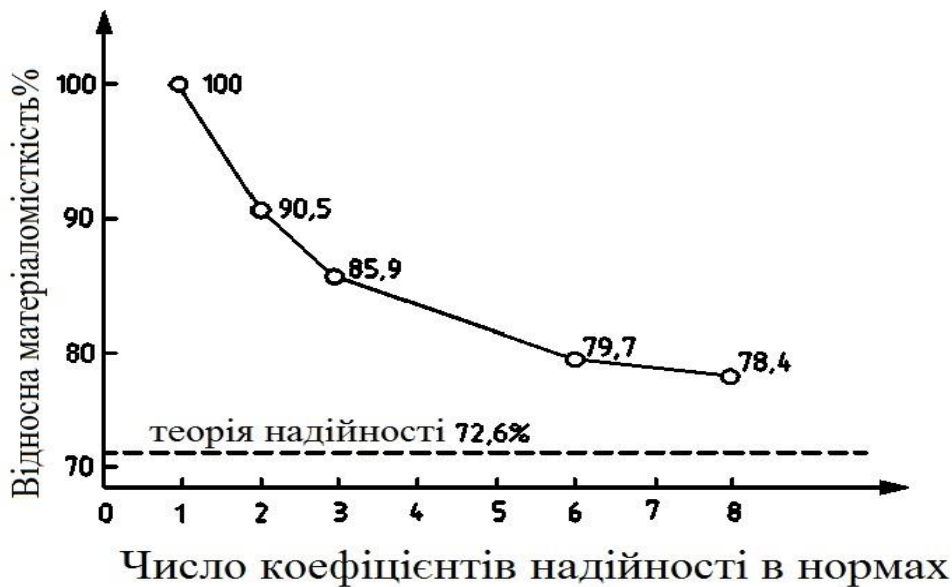
Рисунок 1.22 - Падіння відносної матеріаломісткості зі збільшенням використовуваного числа коефіцієнтів запасу (надійності) при однаковій вірогідності відмови, що допускається.
