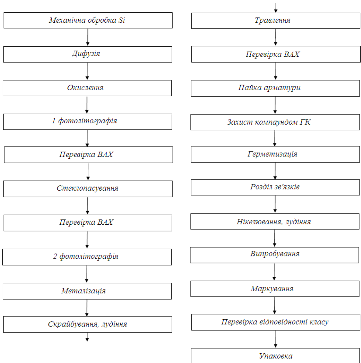
Рисунок 2.1 - Блок-схема технологічного процесу виробництва швидко-відновлюючого діода
