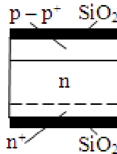
Рисунок 2.5 – Пластина Si після процесу окислення
