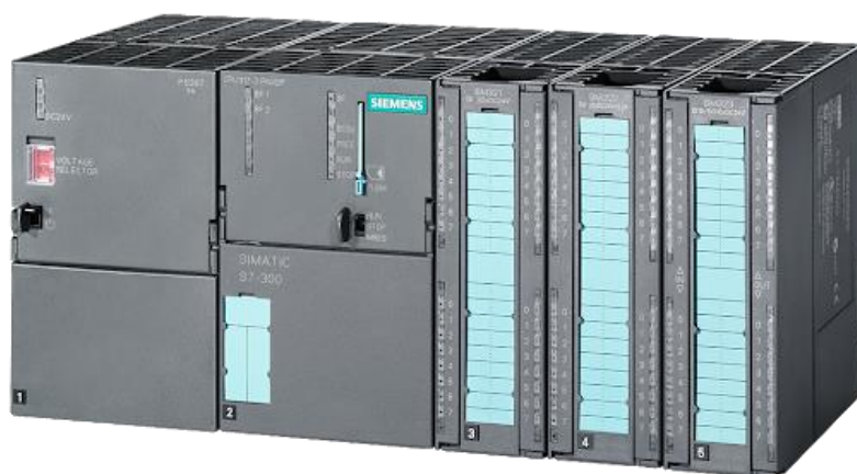
Рисунок 3.15 – Зовнішній вид контролера SIMATIC S7-300
