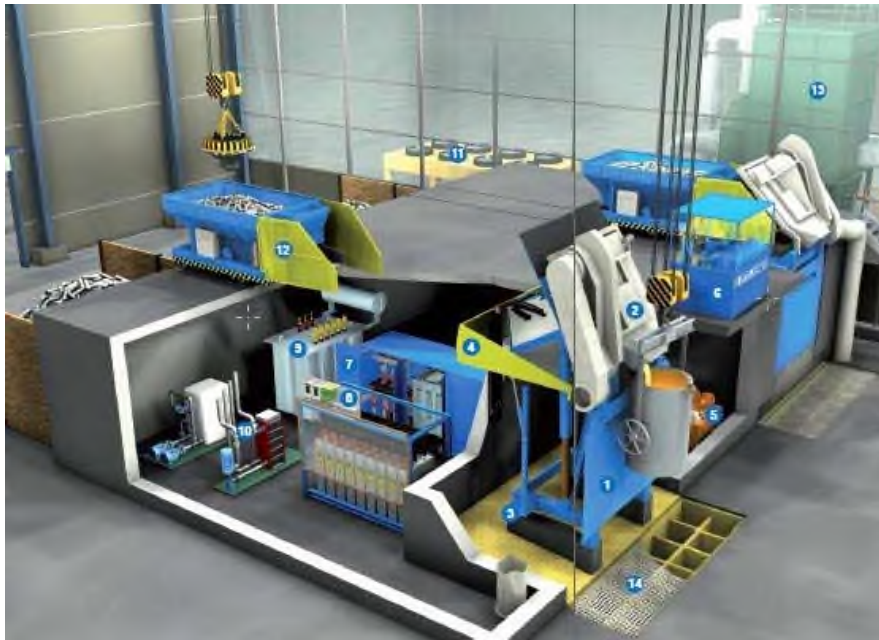
1 – піч; 2 - витяжний ковпак; 3 – система зважування; 4 – захист ями; 5 – гідравлічна силова установка; 6 – панель керування оператора; 7 – перетворювач частоти (DUOMELT); 8 – модуль конденсаторів; 9 – трансформатор; 10 – система водяного охолодження; 11 – повітряний охолоджувач; 12 – завантажувальний пристрій; 13 – система знепилювання; 14 – аварійна накопичувальна яма
