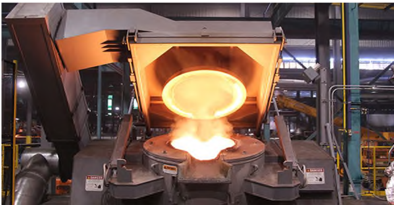
Рисунок 3.2 – Індукційна плавильна піч Inductotherm Europe Ltd. (Англія)
