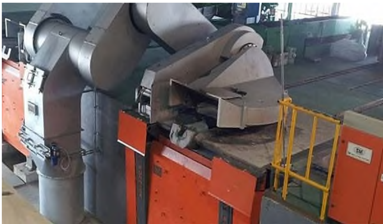
Рисунок 3.6 – Індукційна тигельна піч 5M INDUCTION SYSTEMS (Туреччина)
