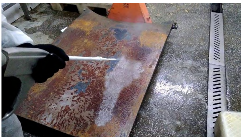
Рисунок 3.3 – Результати застосування кріогенного бластингу для очищення металевих поверхонь від іржі
