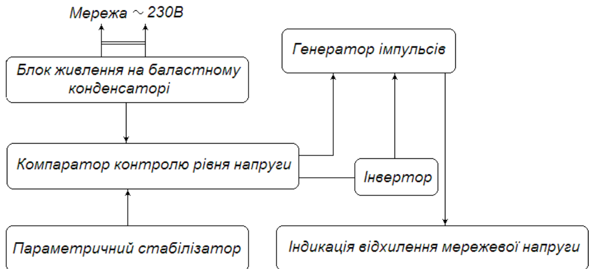
Рисунок 2.1 - Функціональна схема пристрою контролю параметрів мережевої напруги
