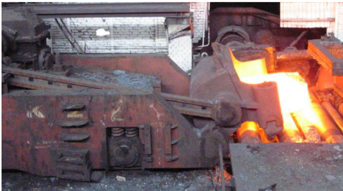
Рисунок 2.5 – Пружинний амортизатор зливковозу обтискного стану
