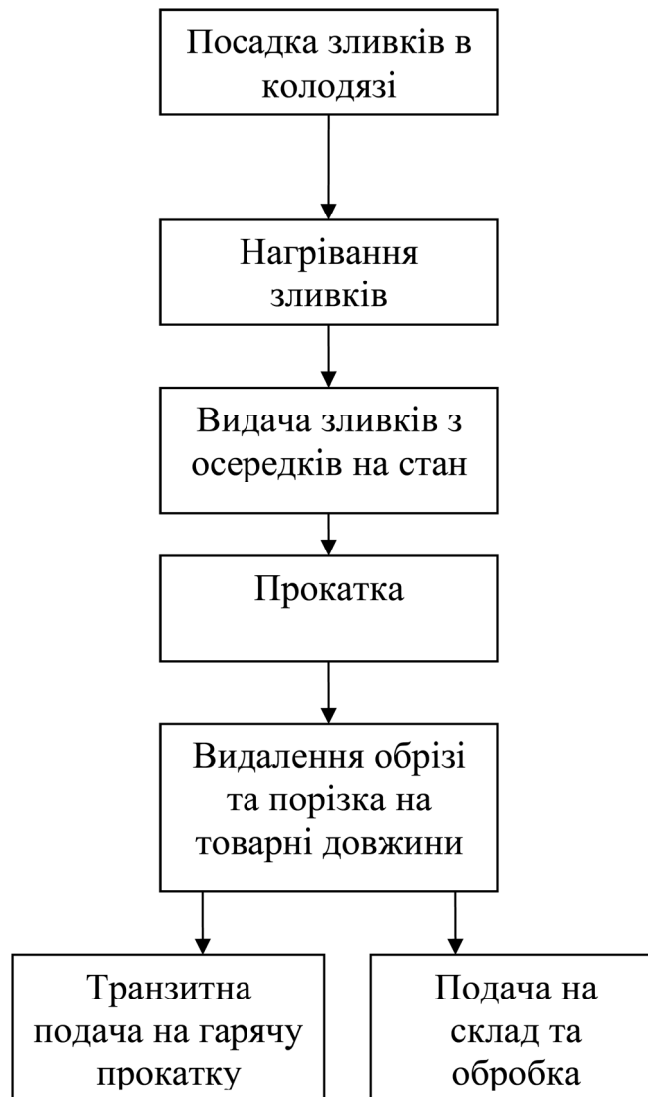
Рисунок 1.3 – Вантажопотоки обтискного цеху
