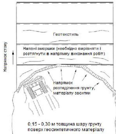
Рисунок 2.3 - Схема насипання ґрунту над полотном геосинтетичного матеріалу на слабкій основі (з модулем деформації більше за 5 МПа)
