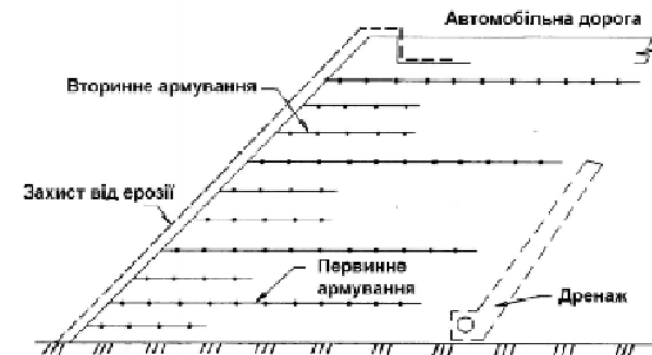
Рисунок 2.5 – Схема армування і стабілізації укосу насипу
