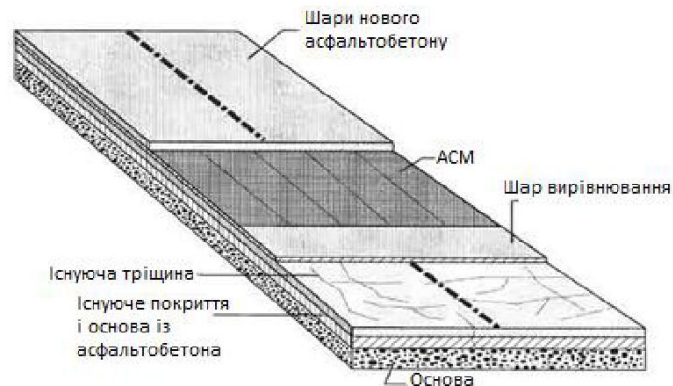
Рисунок 3.4 – Схема армування при реконструкції шарів дорожнього одягу напівжорсткого типу
