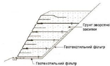
б) фільтри в системі дренажу армованого укосу
