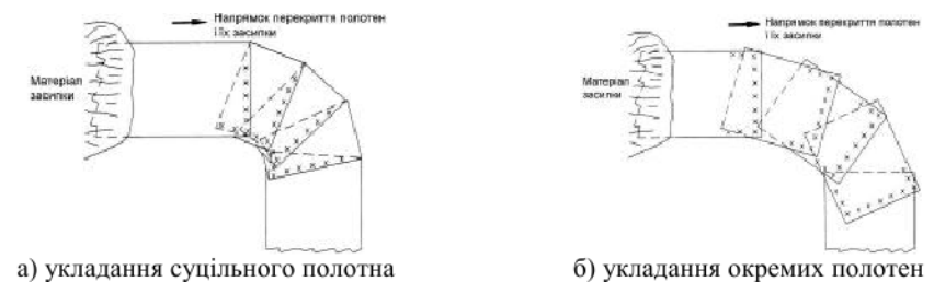
Рисунок 2.18 - Схема вкладання розділяючого геосинтетика в місцях поворотів траси
