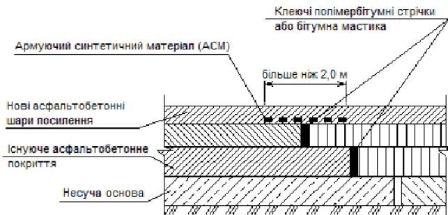
Рисунок 3.8 – Схема поширення конструкцій дорожнього одягу з використанням АСМ (вигляд у поперечному напрямку)
