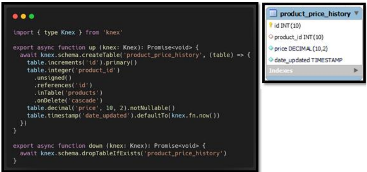
Рисунок 2.7 – Код міграції та таблиця product_price_history у базі даних
