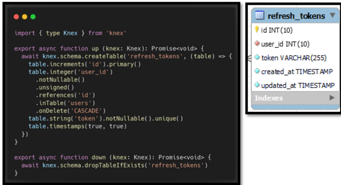
Рисунок 2.15 – Код міграції та таблиця refresh_tokens у базі даних
