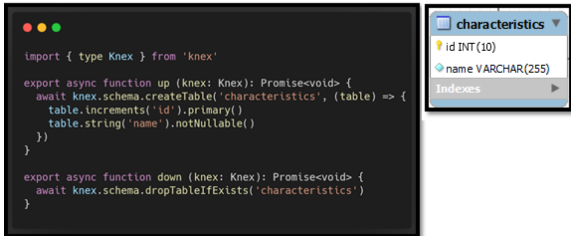
Рисунок 2.9 – Код міграції та таблиця characteristics у базі даних
