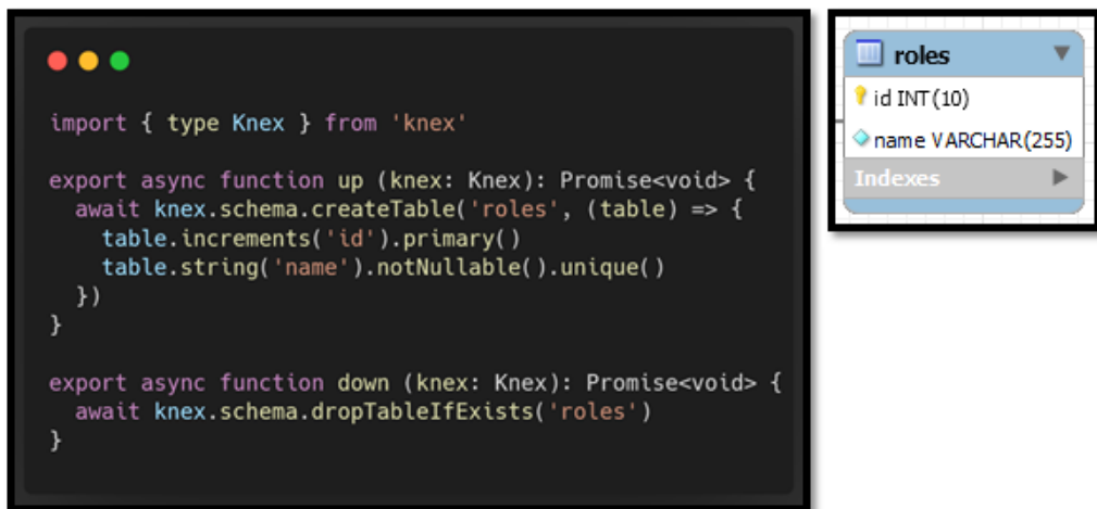
Рисунок 2.13 – Код міграції та таблиця roles у базі даних
