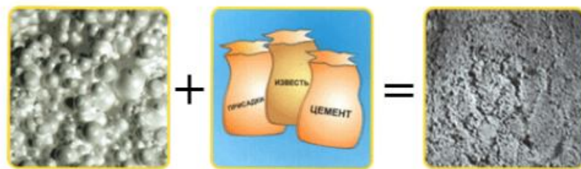
Рисунок 3.5 – «пінопластові шарики» + добавки, присадки=полістиролбетон
