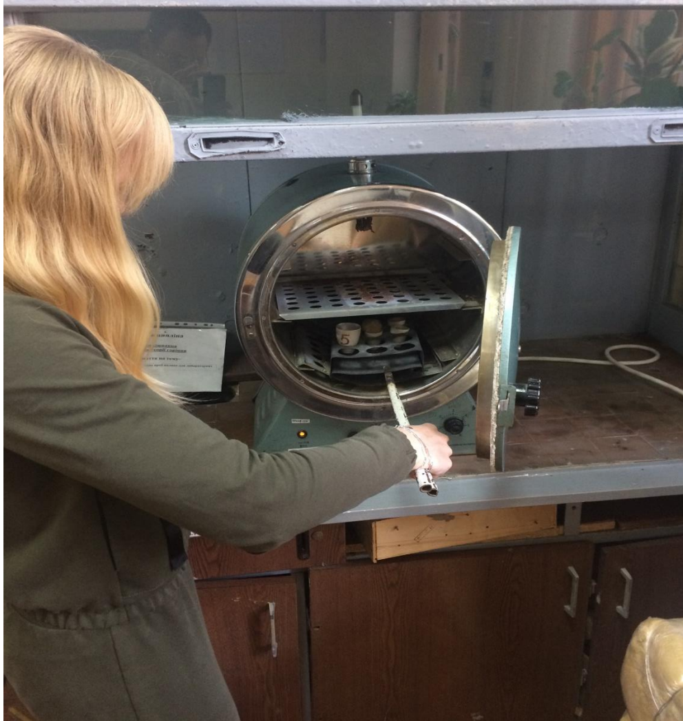
Рисунок 2.2 - Фотографія висушування зразків непрямим прискореним методом
