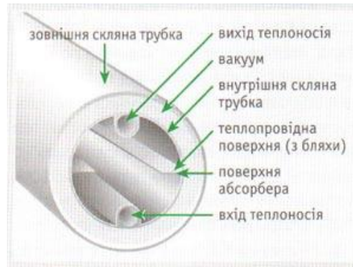
• Рисунок 8 – Переріз трубопроводу колектора
