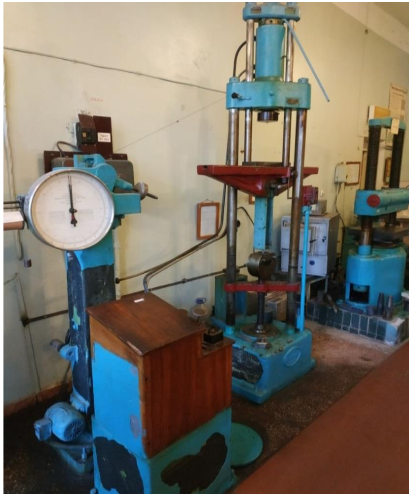
Рисунок 3.3 – Загальний вид розривної машини УГ-20
