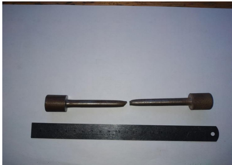
Рисунок 3.7 – Розірваний металевий зразок
