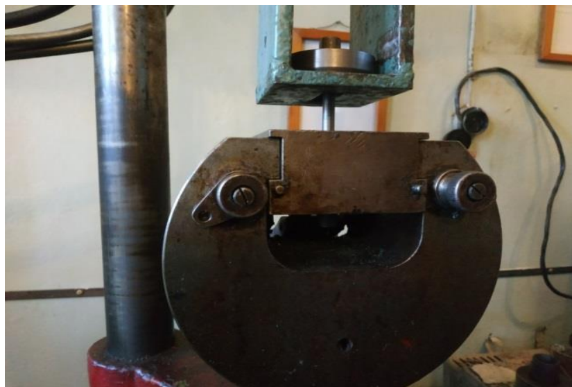
Рисунок 3.5 – Встановлення зразка в розривну машину.
