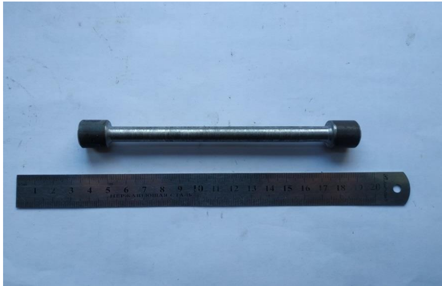
Рисунок 3.4 - Зразок для визначення механічних властивостей
