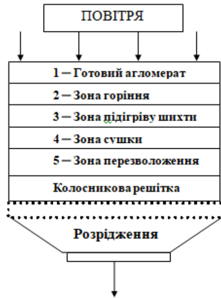
Рисунок 2.4 – Схема процесу спікання
